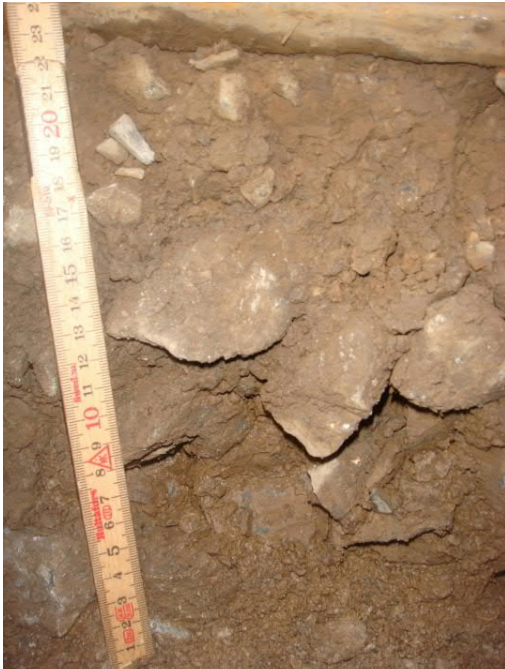
Abb. 5: Reinigbarkeitsklasse S3 (viel Betriebsschmutz und Schotterbruch bzw. -abrieb) ; Porenräume mit kohäsiivem Feinmaterial gefüllt - Verschmutzung von oben bzw. aus dem Schotterbett selbst; nicht mehr wirkungsvoll reinigbar ; Zudem: nur noch einzelne Körner vorhanden
