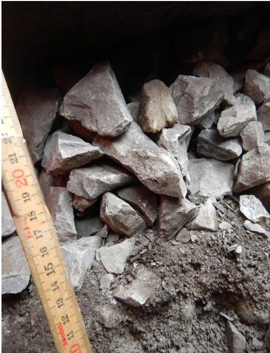
Abb. 1: junges noch nicht verkantetes Schotterbett; Körner weisen nur punktuelle Berührungspunkte auf; beim Öffnen des Handschlitzes fällt auch unter Holz- oder Betonschwellen viel Schotter unterhalb der Schwellen nach; Elastizität im Schotterbett vorhanden
