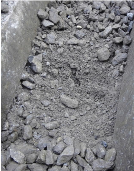
Abb.1: Reinigbarkeitsklasse S2 (wenig Betriebsschmutz und viel Schotterbruch im Stopfbereich) Porenräume mit kohäsionslosem Feinmaterial bzw. Sand gefüllt; nicht mehr genügend Schotterkörner im Stopfbereich vorhanden und daher nicht mehr wirksam stopfbar
