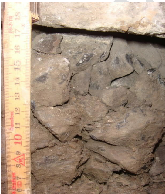
Abb. 3 und 4: fortgeschrittene Einlagerung unterhalb der Schwellen; Porenraum nur noch klein; Schotterbruch und -abrieb lagert sich ein; grosse Kontaktflächen; stark reduzierte Elastizität im Schotterbett; daher hat sich eine Hohlage zwischen UK Schwelle und Schotterbett gebildet (Einsenkung bei Zugsdurchfahrt findet nur noch oberhalb des Schotterbetts statt); Stopfung muss kurzfristig erfolgen
