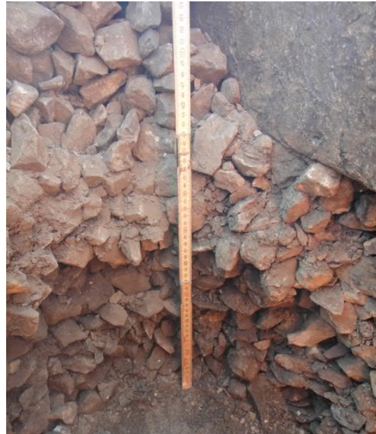
Abb. 4: Reinigbarkeitsklasse S1-2 (wenig bis mittelmässig Betriebsschmutz und Schotterbruch, im Stopfbereich S2). Im Stopfbereich noch ganze Schotterkörner vorhanden und daher noch gerade wirksam stopfbar
