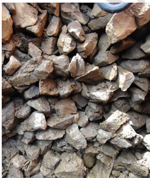
Abb. 3: Reinigbarkeitsklasse S1-2 (wenig bis mittelmässig Betriebsschmutz und Schotterbruch) ; Zudem: gute Korngrössenverteilung, scharfkantig; gegen unten vermehrt Bruch und Schmutz sichtbar (runtergewaschen bzw. – gefallen)
