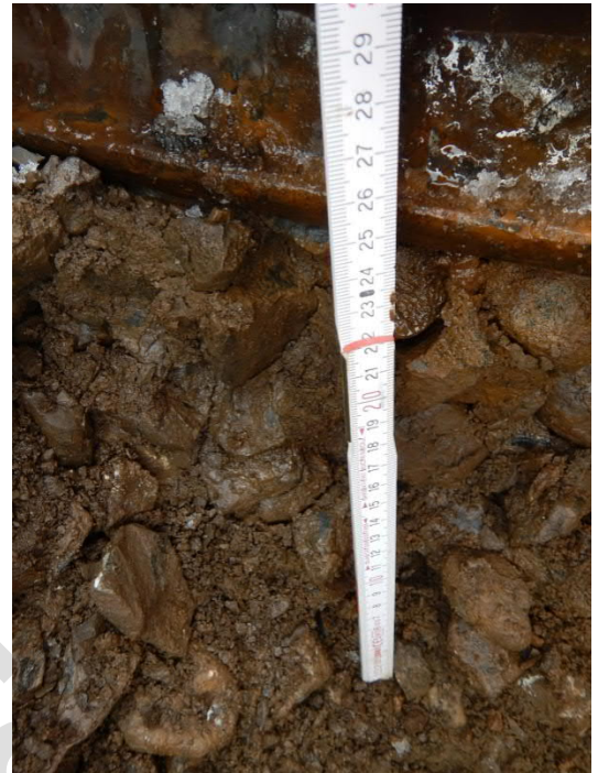
Abb. 6: Reinigbarkeitsklasse S2-3 (mittelmässig bis viel Betriebsschmutz, mittelmässig bis viel Schotterbruch) ; kaum noch Porenräume sichtbar, mehrheitlich mit kohäsionslosem Feinmaterial gefüllt – allerdings bei nasser Witterung Reinigungserfolg reduziert; Test mit Schottergabel vor Ort ergibt einzelne Körner Zudem: Korngrößenverteilung genügend, Körner teils mit Feinmaterial überzogen, kantig bis kantengerundet
