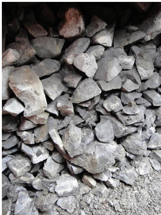
Abb. 1: Reinigbarkeitsklasse S1 (wenig Betriebsschmutz und Schotterbruch) ; Zudem: gute Korngrössenverteilung, scharfkantig; gegen unten gewisse Einregelung sichtbar
