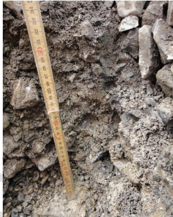
Abb. 2: Reinigbarkeitsklasse S3 (viel Betriebsschmutz und Schotterbruch im Stopfbereich) Porenräume mit kohäsivem Feinmaterial bzw. Sand gefüllt; nicht mehr genügend Schotterkörner im Stopfbereich vorhanden und daher nicht mehr wirksam stopfbar
