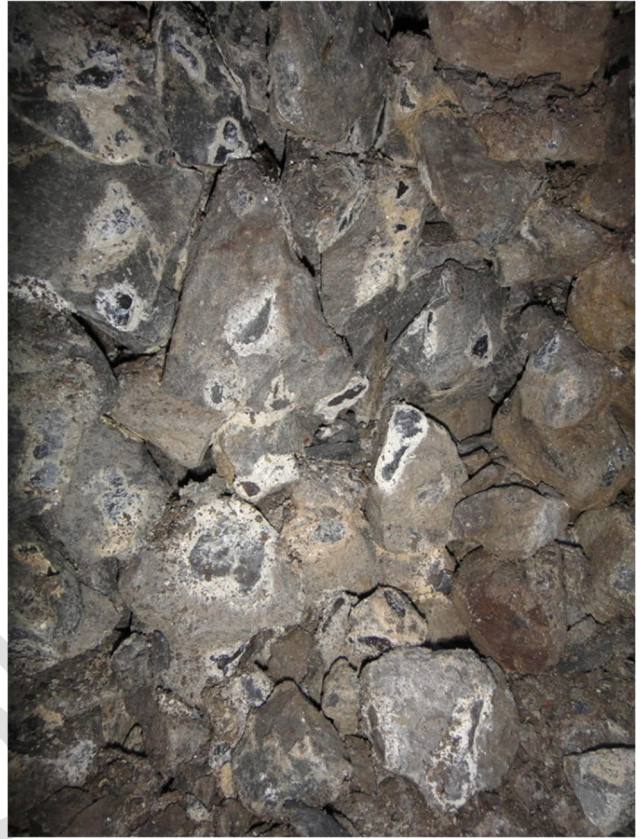
Abb. 1 (oben) und 2 (rechts): Druckstellen aufgrund von Abnutzung der Korn-zu-Korn-Stützung; bei geringer dynamischer Belastung gilt dies als Hinweis für eine ungenügende Festigkeit – bei höherer Belastung kann dies Ausdruck der Überbeanspruchung sein
