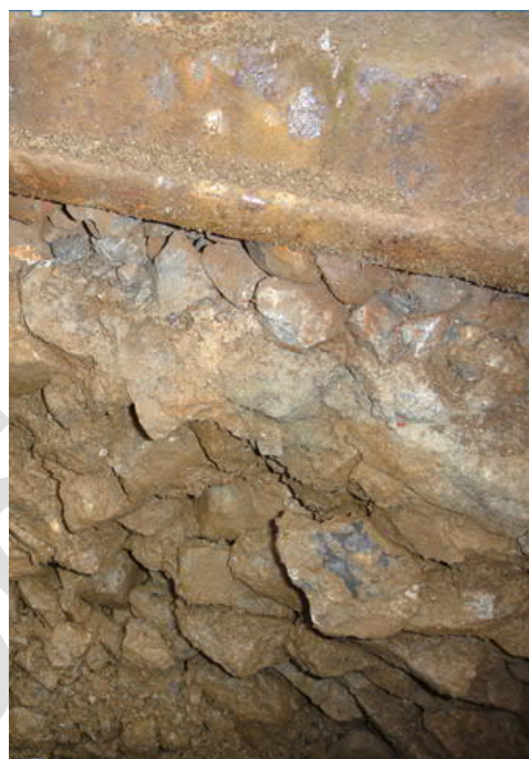
Abb. 2: Reinigbarkeitsklasse S2 (mittelmässig Betriebsschmutz) ; Porenräume sichtbar, z. T. mit kohäsionslosem Feinmaterial gefüllt; Test mit Schottergabel vor Ort ergibt einzelne Körner Zudem: Korngrössenverteilung genügend, Körner teils mit Feinmaterial überzogen, kantig bis kantengerundet
