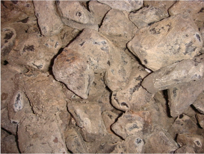
Abb. 1 (oben) und 2 (rechts): Druckstellen aufgrund von Abnutzung der Korn-zu-Korn-Stützung; bei geringer dynamischer Belastung gilt dies als Hinweis für eine ungenügende Festigkeit – bei höherer Belastung kann dies Ausdruck der Überbeanspruchung sein
