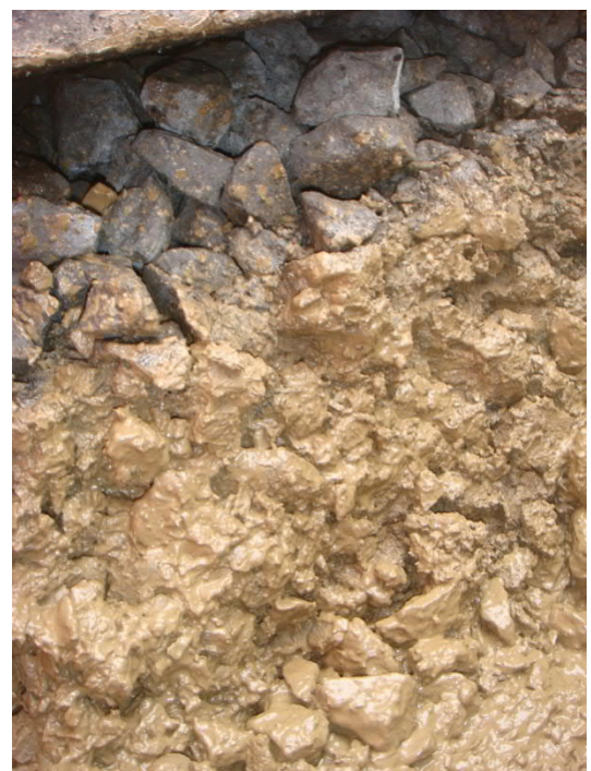
Abb. 7 und 8: Reinigbarkeitsklasse S4 (Feinmaterialaufstoss von unten) ; kaum noch Porenräume sichtbar, mehrheitlich mit kohäsiivem Feinmaterial gefüllt – nicht mehr reinigbar ; Test mit Schottergabel vor Ort ergibt Klumpen bzw. Aggregate
