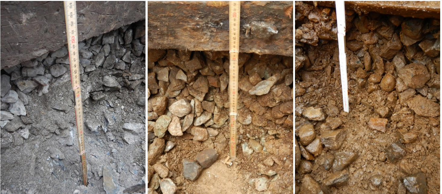
Abb. 7 - 9: Profil durchs Schotterbett; Doppelmeter auf Planie; Eindruck Körnigkeit, Reinigbarkeit (bei allen Bsp. Gegeben); Eindruck Schotterbettdicke; basale Verschmutzung (links: im unteren Bereich vermutlich Rückstände der letzten Fahrbahnerneuerung (Reinigungshorizont))
