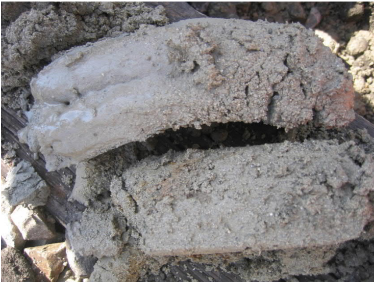
Abb. 13: Materialbeschaffenheit anhand Aushubfoto (Handbohrer; hier mit abnehmender Konsistenz der Feianteile)
