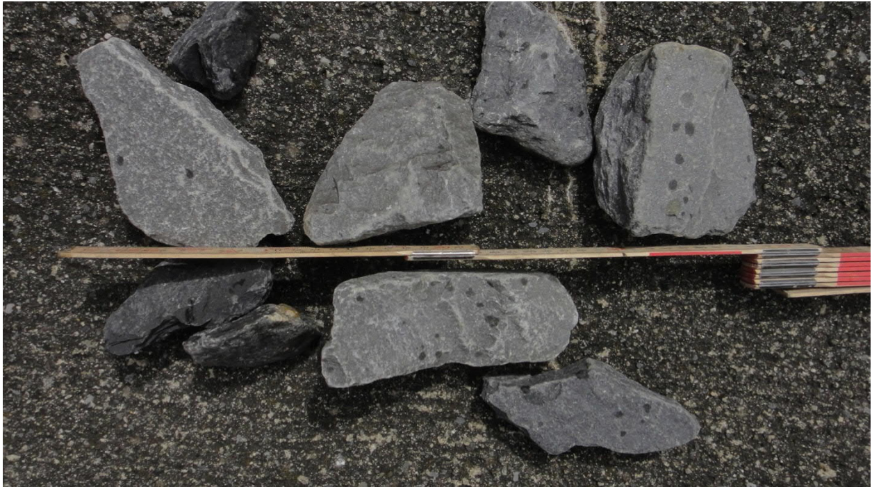
Abb. 5: mehrheitlich kantengerundete Körner (Neuschotter)
