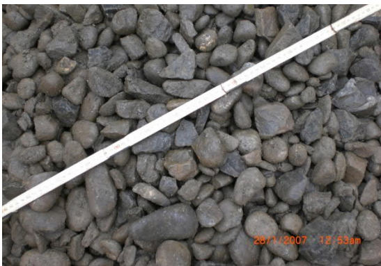
Abb. 3 - 5: Evtl. Detailaufnahmen Schotter: Besonderes wie weisse Stellen / „Schotterfliessen“ (links), Stopfbereich (Mitte) und hoher Anteil Rundkorn (rechts)
