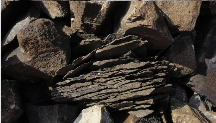
Abb. 3 und 4: Nicht frostbeständige Körner (darf nur <5% Massenprozent ausmachen)
