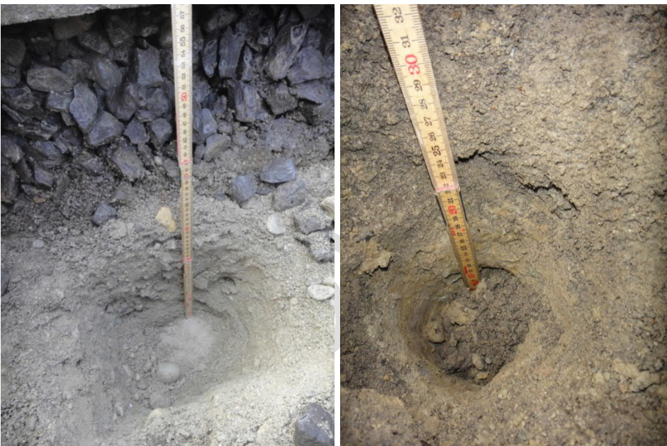
Abb. 7 - 9: Profil durchs Schotterbett; Doppelmeter auf Planie; Eindruck Körnigkeit, Reinigbarkeit (bei allen Bsp. Gegeben); Eindruck Schotterbettdicke; basale Verschmutzung (links: im unteren Bereich vermutlich Rückstände der letzten Fahrbahnerneuerung (Reinigungshorizont))
